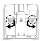
バッテリーパックのケーブル先のオス側コネクタと本体のメス側コネクタが合致するようにコネクタを接続し、ケーブルを隙間へ軽く折込んだ後バッテリーパックを、セットします。
