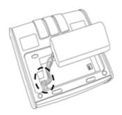
バッテリーカバーを取り付け、バッテリーカバーオープンレバーを水平方向に戻します。
